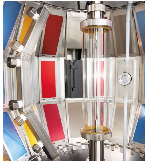
キセノンウェザーメーター内のブラックパネルセンサ (画像中央の黒い部分)
